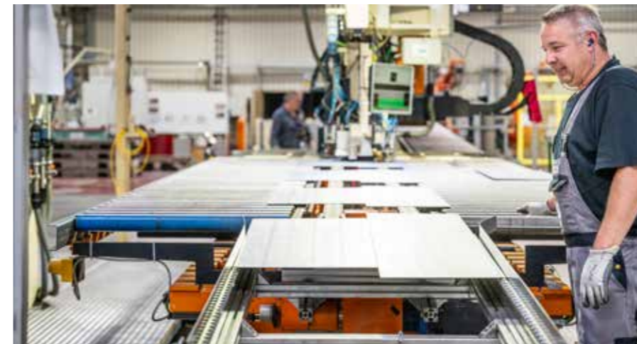
oben: Auslauf an der Laserschweißanlage für Tailored Aluminum Blanks [TAB®].
