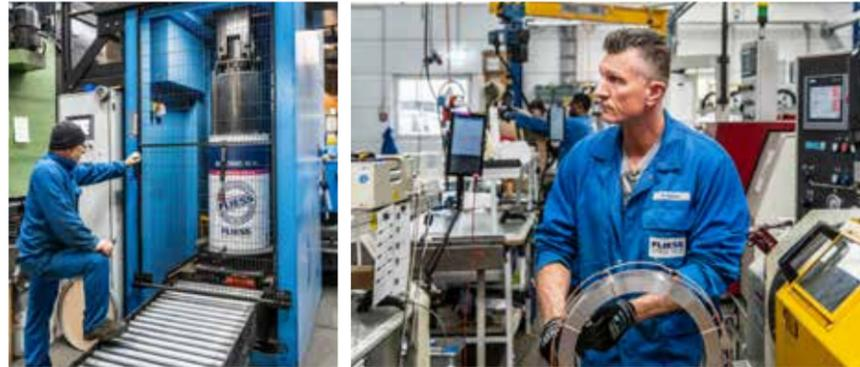
Vom Grobzug [oben] geht es weiter zum Feinzug [unten], durch den der Stahl noch dünner wird. Wenn der vom Kunden gewünschte Durchmesser erreicht ist, wird das fertige Produkt auf handliche Spulen gewickelt und verpackt.
