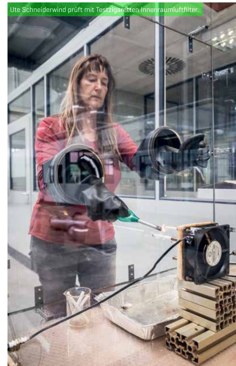
Mitarbeiter richten einen Filterprüfstand für Versuche zur Reduzierung von Stickstoffoxiden ein.
